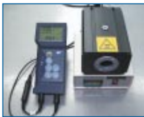
CBB171 mit Referenzmessgerät P655 (siehe Set CAL 1+2)
