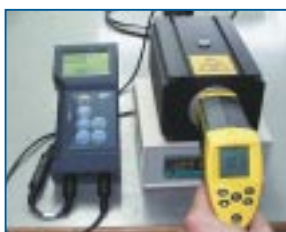
Überprüfung eines Infrarotmessgerätes Verification of an infrared thermometer
