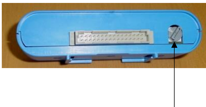
Drehschalter zur Einstellung des TC
