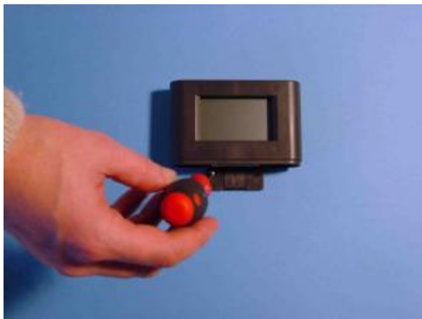
Bild: Befestigen eines OPUS 10
