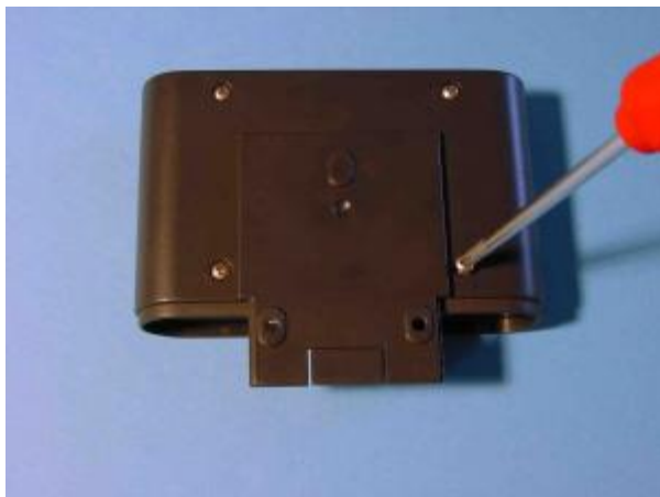
Bild: Öffnen des OPUS10 für Batteriewechsel
